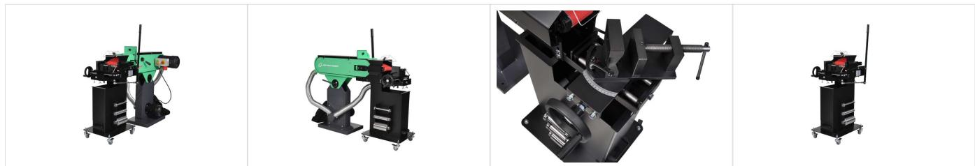
M TAS 75RB/RBX est avant tout une meuleuse de tubes, qui meule des tubes dans toutes les variantes : Tubes ronds, carrés et pleins - d'un diamètre de Ø17 mm à un Ø maximum de 70 mm.
