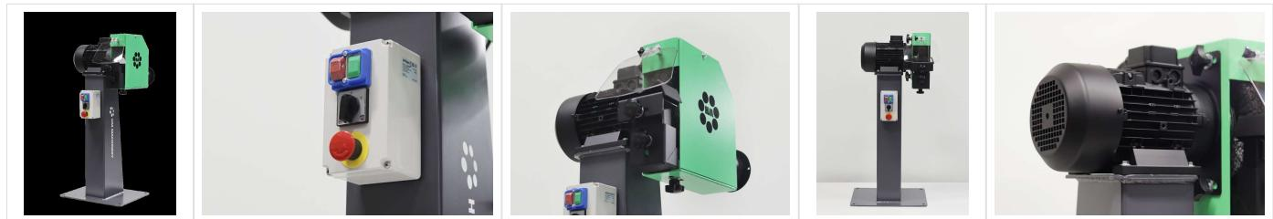
L'ébavureuse de tubes HM modèle ZP 45 peut supprimer les bavures à l'intérieur et à l'extérieur des tubes en une seule opération, en utilisant ainsi le temps de travail d'ébavurage.
