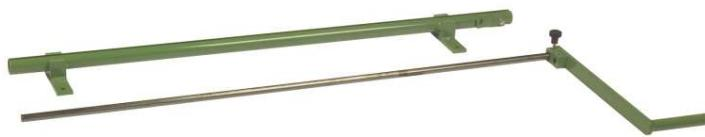
Machine à perler HM NV-1A en longueur 1020 mm Equipement standard : 1 machine à perler 1 tige à perler Ø 12mm 1 poignée de commande
