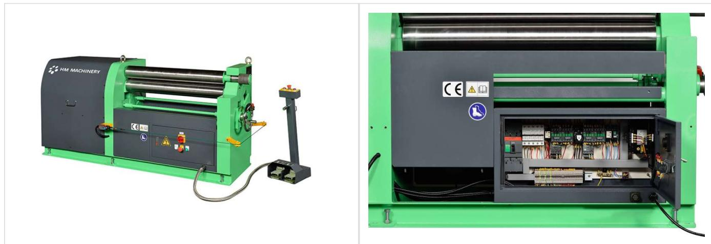
Les rouleaux de cintrage motorisés MRM sont construits avec des pignons en acier massif et ont une conception de surface propre avec un rayon souple moderne.
