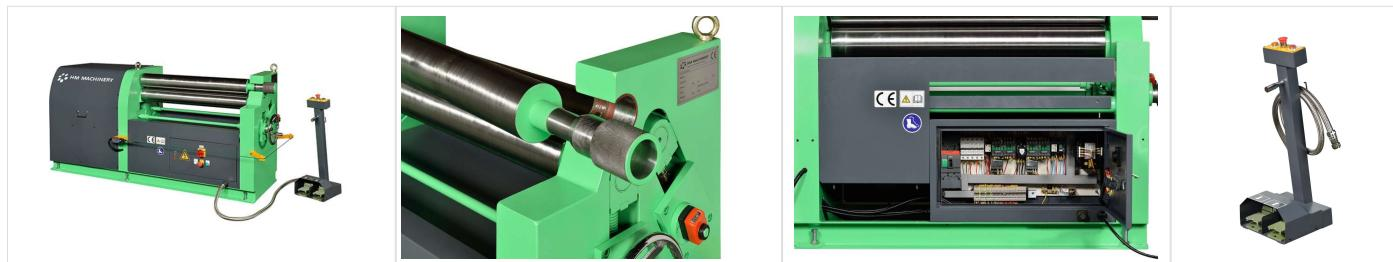
Les rouleaux de cintrage motorisés MRM sont construits avec des pignons en acier massif et ont une conception de surface propre avec un rayon souple moderne.
