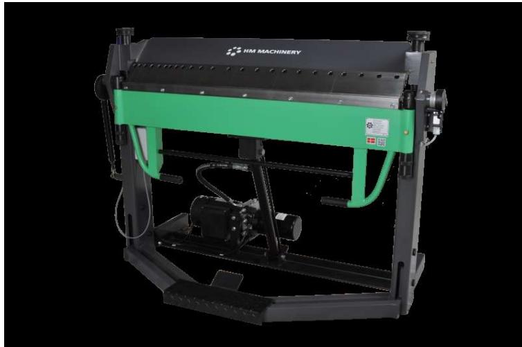
Les cintreuses de chants modèle HS 2AS ERGO et HS 3S ERGO sont en fait des machines manuelles qui sont rendues motorisées à l'aide d'un vérin auxiliaire hydraulique spécialement développé.
