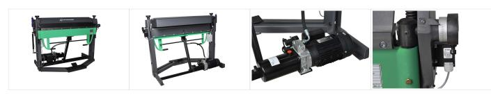
La nouvelle gamme de plieuses HS 2AS ERGO et HS 3S ERGO, sont en fait des machines manuelles, qui ont été optimisées pour offrir une option motorisée très efficace via un système de vérin de support de poutre pliante en attente spécialement développé et breveté.
