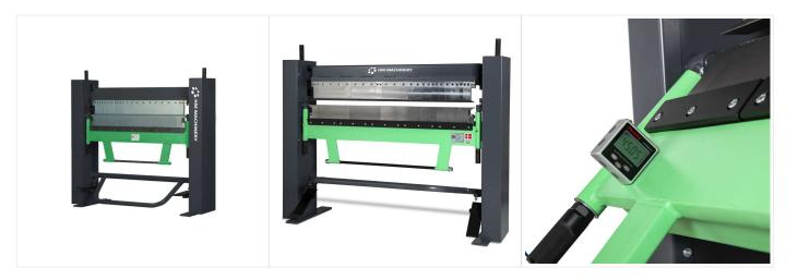
Les cintreuses de chants modèle Superflex sont une nouvelle génération de cintreuses de chants avec des barres supérieures, inférieures et de cintrage segmentées pour le cintrage opposé, ce qui signifie un nombre énorme de possibilités pour le cintrage de profilés spéciaux.
