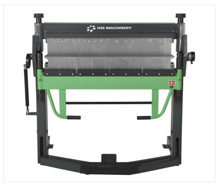
Les cintreuses de chants modèle Superflex sont une nouvelle génération de cintreuses de chants avec des barres supérieures, inférieures et de cintrage segmentées pour le cintrage opposé, ce qui signifie un nombre énorme de possibilités pour le cintrage de profilés spéciaux.
