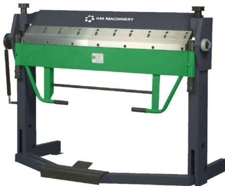
Les plieuses HM modèles HS2A et HS3 sont fabriquées avec une poutre supérieure à plusieurs faisceaux et actionnée au pied pour permettre une utilisation mains libres simple et rapide.
