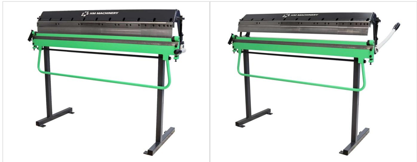
Les modèles de plieuses MB MB 700L - 1300L sont des machines manuelles, légères et simples d'utilisation, particulièrement adaptées au pliage de tôles fines.
