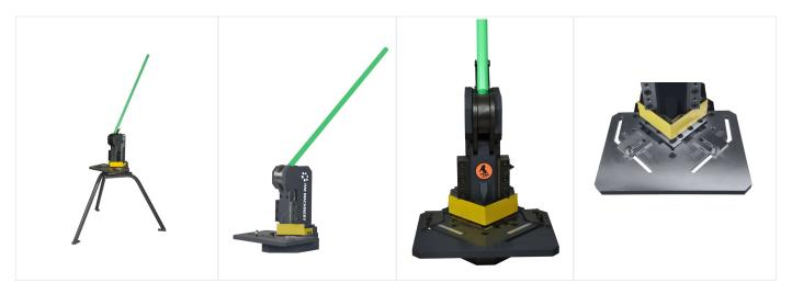
HM manuelle Eckenschere Modell ES 100/30 erlaubt durch ihre stabile Konstruktion schnelle, einfache und kostengünstige Ausklinkarbeiten von Blechen bis zu 3,0 mm Stärke (400 N/mm²).
