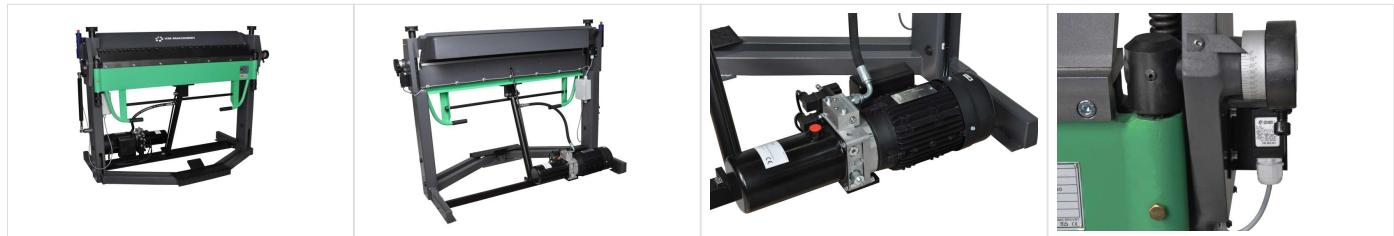
Die Schwenkbiegemaschinen HS 2AS ERGO und HS 3S ERGO sind weiterentwickelte manuellen Maschinen, die mittels einen neu entwickelten und patentierten Hilfzylinder, motorisiert wurden.
