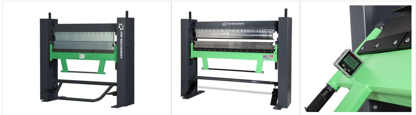
Die Schwenkbiegemaschinen Modell Superflex, eine neue Generation von Schwenkbiegemaschinen mit Segmenten in Ober-, Unter- und Biegewange für entgegengesetzte Biegungen, woraus sich eine enorm große Anzahl von Biegemöglichkeiten für Spezialprofile ergibt.
