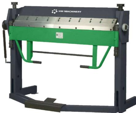
HM Schwenkbiegemaschinen Modell HS-2A und HS-3 sind manuelle fußbedienbare Maschinen mit Multischiene, wo die Oberwange das Biegeobjekt festhält.
