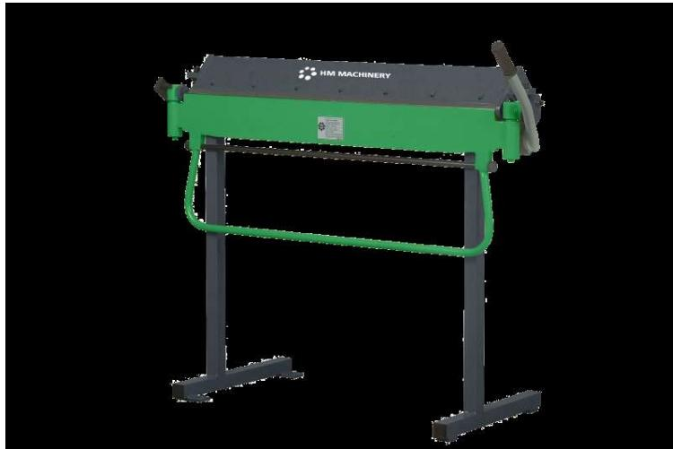
Die manuellen Schwenkbiegemaschinen Modell MB 700L - 1300L sind edienungsfreundliche Maschinen, die in Leichtbauweise, zum Biegen von Dünnblechen hergestellt sind.
