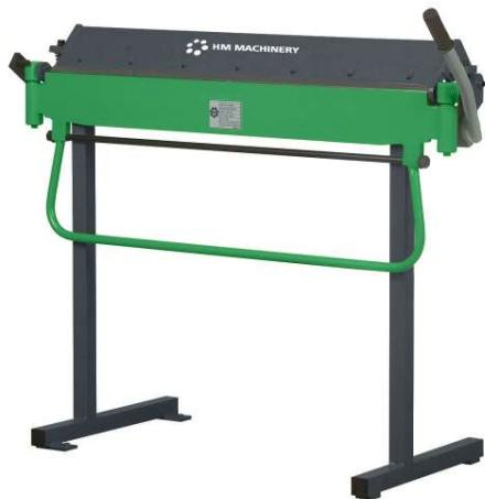
Die manuellen Schwenkbiegemaschinen Modell MB 700L - 1300L sind bedienungsfreundliche Maschinen, die in Leichtbauweise, zum Biegen von Dünnblechen hergestellt sind.
