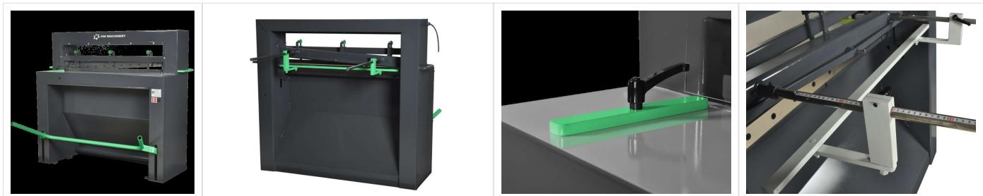
Die Blechscheren Modell CS 100 und CS 125 sind überaus genau arbeitende, fußbediente Maschinen, optimal zum Schneiden von Metall und Kunststoff.
